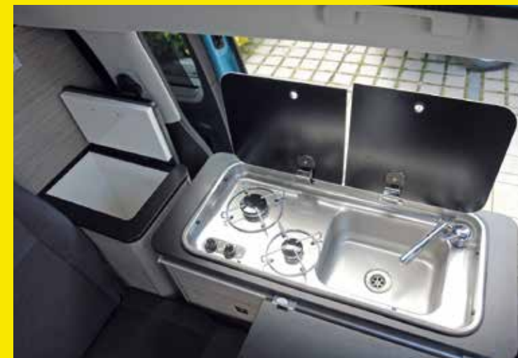
Die Küchenzeile eingebaut. Trotzdem lässt sich die zweite Schiebetür öffnen. Die Kühlbox links ist fest verbaut.
