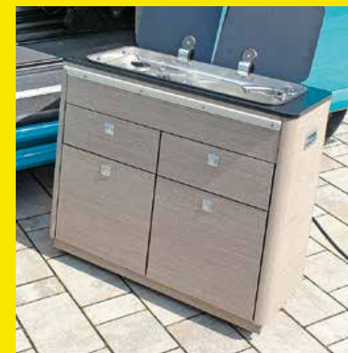
Das Modul: Kocher, Waschbecken und zwei Tanks rechts unten drin. Ein Kabel versorgt die Pumpe.
