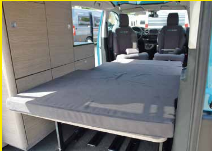
Eigens von Pössl entwickelte Schlafsitzbank. Dank Schienensystem kann die Sitzplatzanzahl auf bis zu sieben anwachsen.
